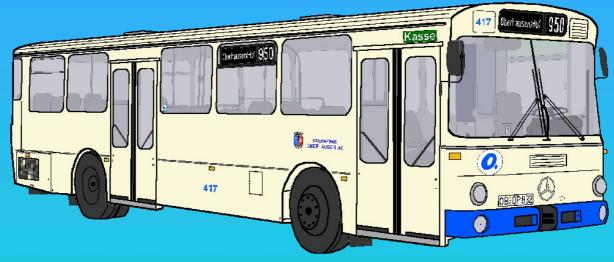
Hier entsteht eine Homepage über die Geschichte, die Technik, die Restauration und die Erhaltung des historischen Linienbusses 417 der Stadtwerke Oberhausen AG (STOAG). Der Mercedes O 305 (Stadtbus SL 1 mit StÜLB-Front) wurde 1986 gebaut und bis 1999 im Linienverkehr eingesetzt. Von 1999 bis 2010 stand er in Diensten der Berufsfeuerwehr Oberhausen und ist seit 2010 in Privatbesitz.
